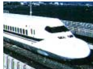
新幹線ボディにもアルミ大型押出材
